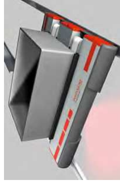
De SmartCarrier van Swislog is een shuttle die zowel van niveau als van gang kan wisselen
